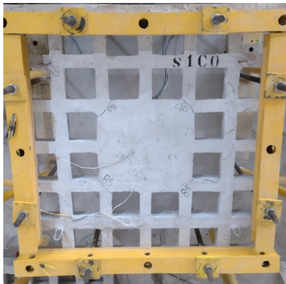
Figura 8.82 – Mapa de fissuração da laje versus panorama de fissuração do modelo (S1C0)
