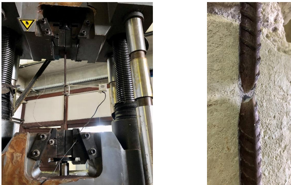
Figura 8.5 – Ensaio de tração do aço
