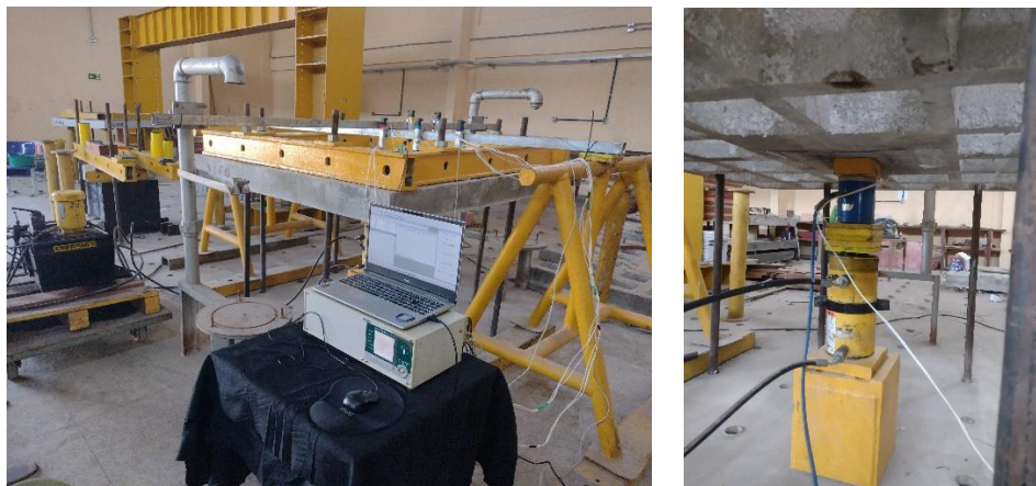
Figura 3.19 - Sistema de ensaio das lajes
