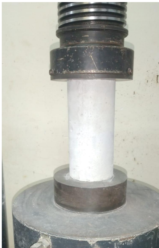
Figura 8.2 – Ensaio para determinação da resistência à compressão do concreto
