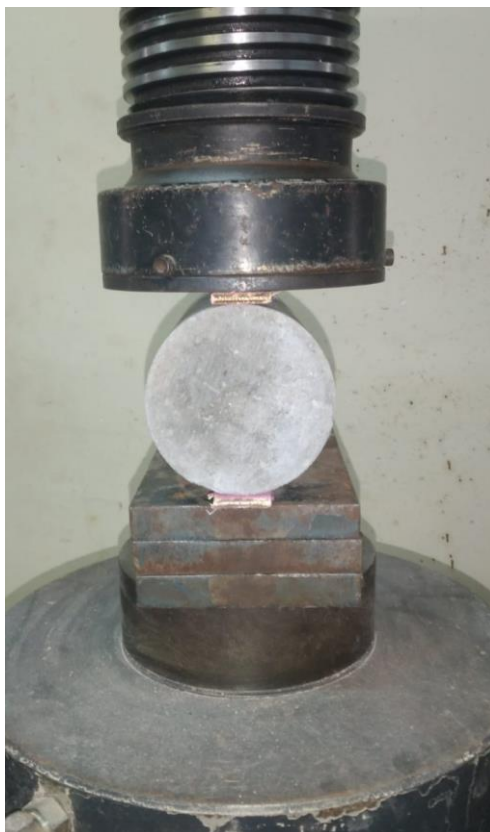
Figura 8.3 – Ensaio para determinação da resistência à tração por compressão diametral
