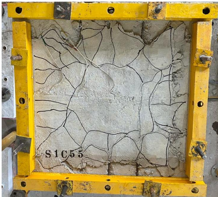
Figura 8.27 – Mapa de fissuração e superfície de ruptura da laje S1C55
