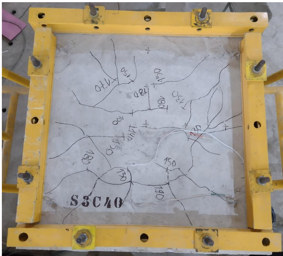
Figura 8.26 – Mapa de fissuração e superfície de ruptura da laje S3C40
