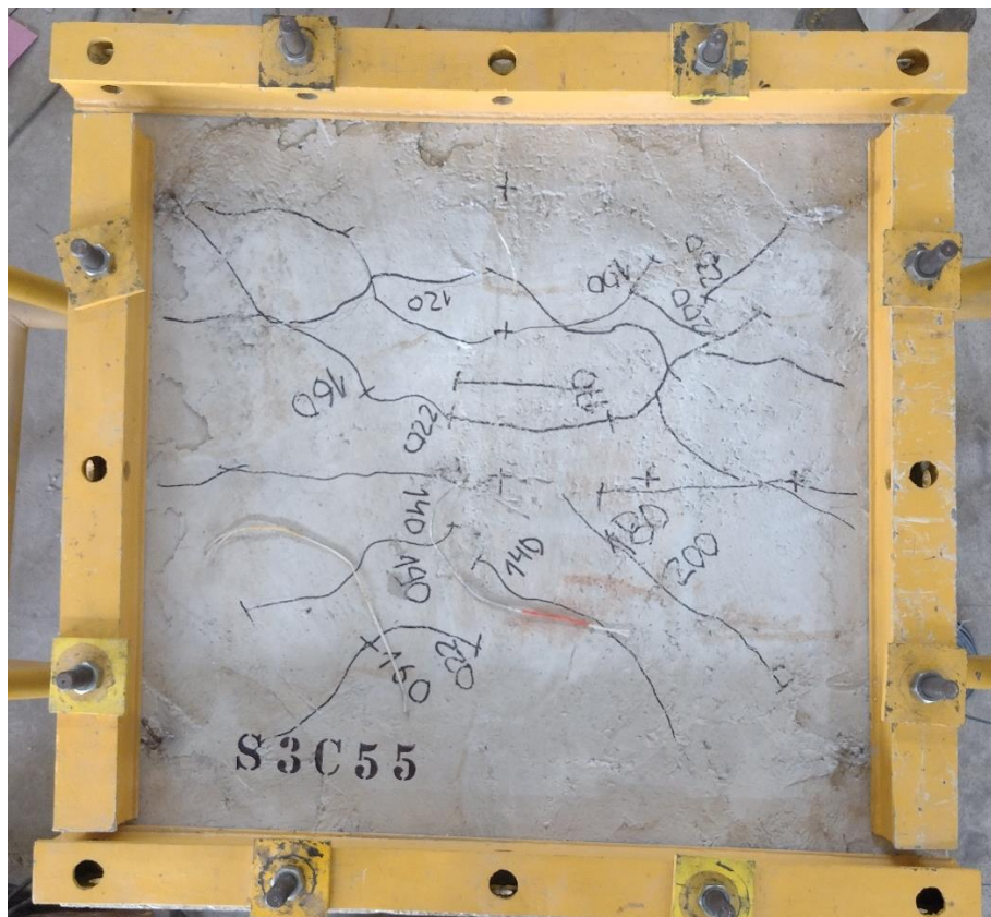
Figura 8.29 – Mapa de fissuração e superfície de ruptura da laje S3C55
