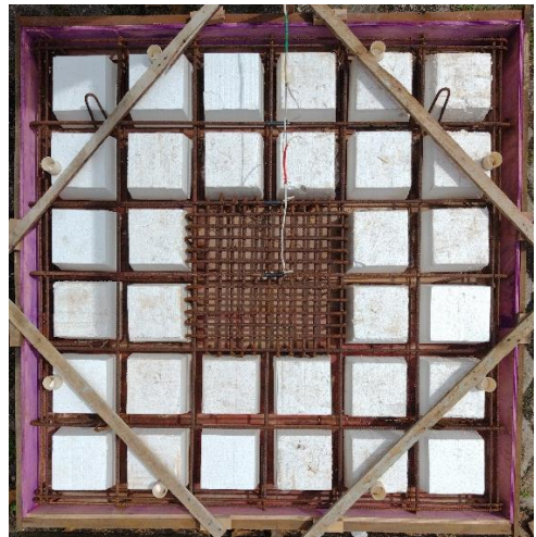
Figura 3.21 - Instrumentação das barras de aço
