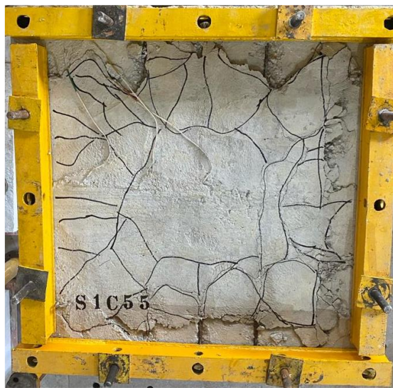
Figura 8.88 – Mapa de fissuração da laje versus panorama de fissuração do modelo (S1C55)
