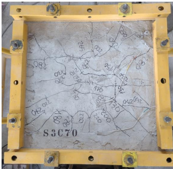
Figura 8.93 – Mapa de fissuração da laje versus panorama de fissuração do modelo (S3C70)
