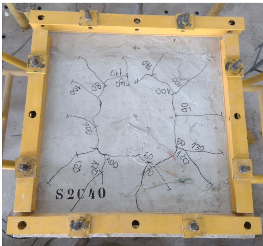
Figura 8.25 – Mapa de fissuração e superfície de ruptura da laje S2C40
