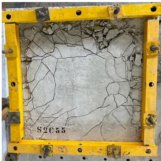
Figura 8.89 – Mapa de fissuração da laje versus panorama de fissuração do modelo (S2C55)
