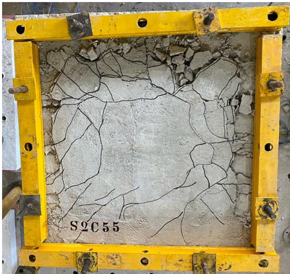
Figura 8.28 – Mapa de fissuração e superfície de ruptura da laje S2C55
