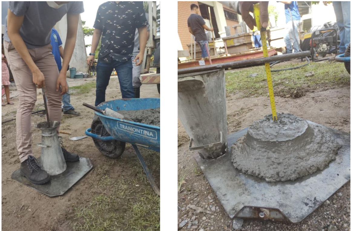
Figura 3.14 - Ensaio de abatimento do tronco de cone ( Slump Test )
