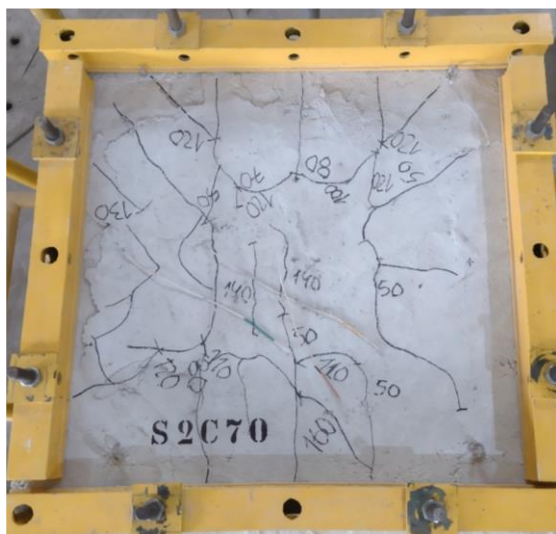
Figura 8.92 – Mapa de fissuração da laje versus panorama de fissuração do modelo (S2C70)
