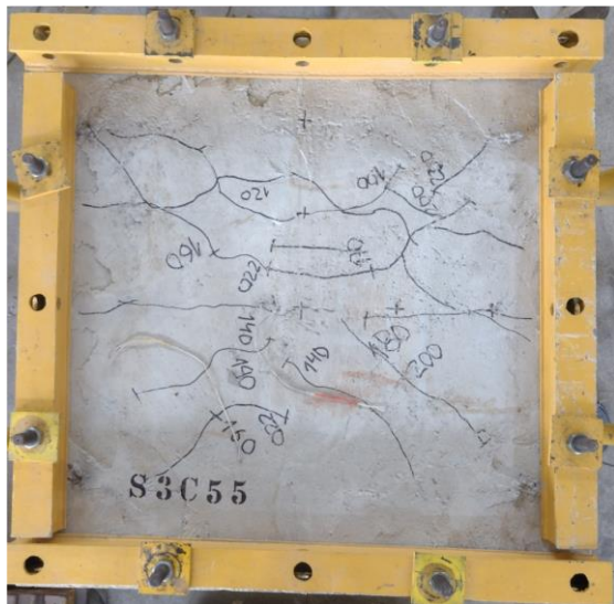
Figura 8.90 – Mapa de fissuração da laje versus panorama de fissuração do modelo (S3C55)
